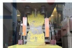
鋼梁翼板從削翼處斷裂 (G1-7 試體破壞)
